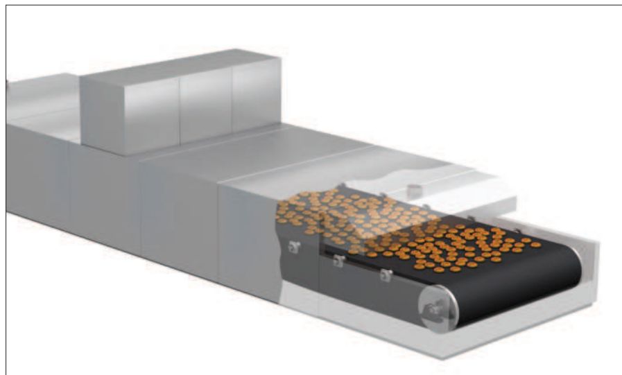
Хлебопекарные печи непрерывного действия, использующие высокотемпературные шарикоподшипниковые узлы в опорах конвейера.
