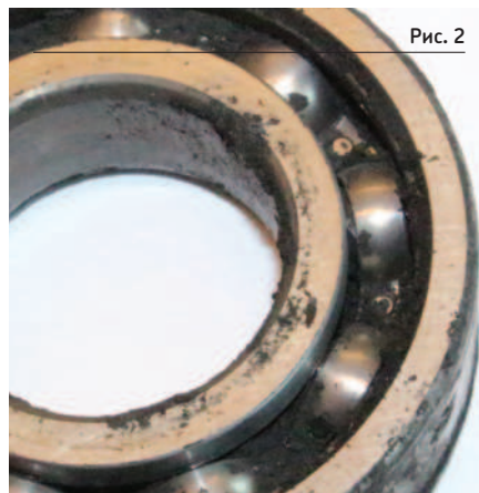
Пластичная смазка может закоксовываться и блокировать подшипник при высоких рабочих температурах
